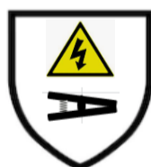
Resistência a Corrente Elétrica / Isolação
