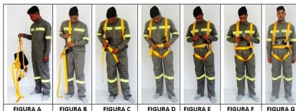
**3. ELEMENTOS DE ACOPLAMENTO:** A argola tipo “D” no dorso do cinturão, marcada com a etiqueta “A”, para ancoragem e proteção contra quedas e resgate. Duas argolas tipo “D” laterais marcadas com as etiquetas “P”, somente para posicionamento. Duas alças frontais marcadas com as etiquetas “A/2”, para resgate e posicionamento.
